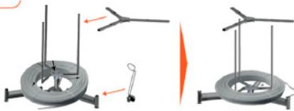
3. Coloque la bobina de tubería en la base con rodillos. (para montar correctamente la bobina de tubería no debe soportar el peso de la tubería: hágalo rodar hasta el desbobinador y cargue el rollo inclinándolo sobre la base).
