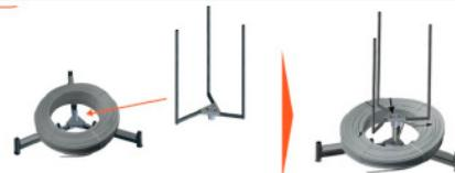
2. Inserte las patas del desbobinador en el elemento giratorio y apriete los tornillos.
