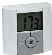
Cronotermostato de ambiente electrónico digital con programación semanal para instalaciones de calefacción y refrigeración. Cuenta con pantalla LCD retroiluminada para la visualización constante de la temperatura ambiental, hora, estado de funcionamiento y 2 niveles de temperatura (confort y reducida nocturna), función antihielo (0,5-10°C).
