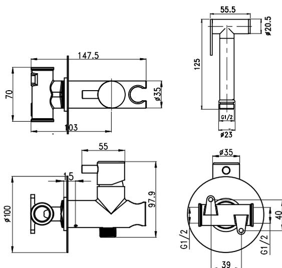
El conjunto ducha para inodoro empotrada dos aguas (fría y caliente) se suministra en kit completo con todo lo necesario para su instalación, además de la propia ducha de mano con corte de agua, monomando mezclador, toma de agua con nivel y flexo.
