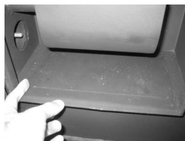
Figura 214 – Limpieza del interior de la estufa
