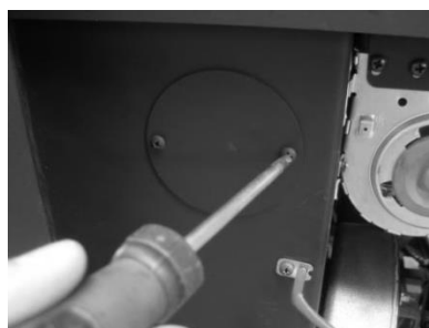
Figura 22 – a) Retirar las tuercas de mariposa; b) Retirar la tapa
