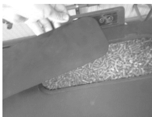
Figura 15 – Reabastecimiento del depósito de pellets
