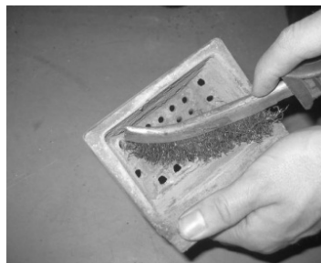
Figura 203 – Limpieza del cestillo de quema
