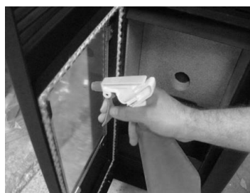
Figura 55 – Limpieza incorrecta del vidrio
