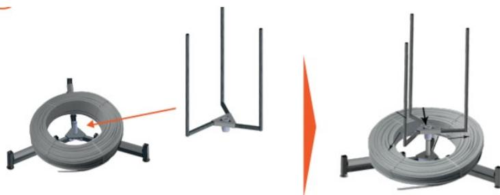
5. Instale la guía de la tubería y el peso.
