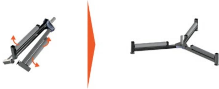
2. Inserte las patas del desbobinador en el elemento giratorio y apriete los tornillos.
