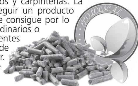
**Para nuestras estufas se tiene que utilizar pellets de 6 mm de diámetro, longitud de 30 mm y con una humedad máxima del 8% certificado EN Plus A1 SK002 UNI EN ISO 17225-2. Es recomendado almacenar el pellets lejos de fuentes de calor y en lugares sin humedad o sin atmósferas explosivas. La empresa aconseja utilizar combustible certificado.**
