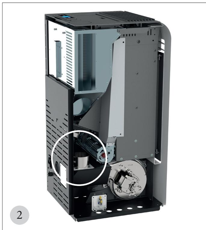
Hay la posibilidad de desplazar la salida de humos en vertical. En este caso es necesario taponar la salida de humos trasera y colocar el tubo de conexión hacia la parte superior. No es necesario utilizar la junta a "T".
