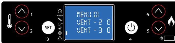
4. Para apagar el ventilador de la canalización, seleccione la velocidad a 0.
