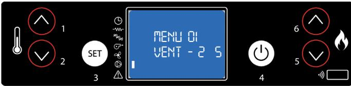
3. Establecer la velocidad utilizando los botones 1 y Con la tecla 1 se establece la velocidad del ventilador canalizado.
