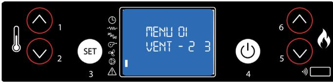
2. Pulsando otra vez la tecla SET se entra al menú para ajustar la velocidad del ventilador canalizado.
