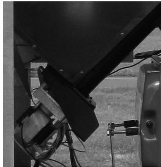
**Motorreductor:** si el motorreductor se detiene, la Termoestufa sigue funcionando hasta que no se apaga la llama por falta de combustible y hasta alcanzar el nivel mínimo de enfriamiento.
