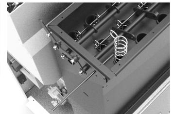
*La operación debe realizarse desenroscando los casquillos de fijación con un destornillador (foto 1).*
