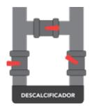
Abrir ½ del recorrido de la Válvula de entrada del Bypass y dejar que lentamente se vaya llenado la botella. Por el desagüe, podremos oír como escapa el aire. Mantener hasta que salga todo el aire. Lo sabremos porque por el desagüe, ya sale agua y sin Burbujas.
