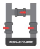
Se debe asegurar que las válvulas de entrada y salida del descalcificador están cerradas y que el By-pass está abierto para asegurar la disponibilidad de agua en la instalación.
