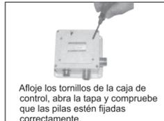
Aflore los tornillos de la caja de control, abra la tapa y compruebe que las pilas estén fijadas correctamente.
