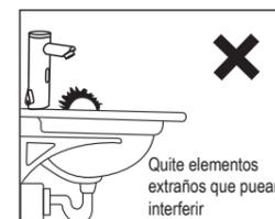
Quite cualquier elemento extraño que pueda interferir en el sensor y, por tanto, en el funcionamiento del grifo.
